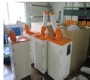
【スポットクーラーとダクト】
